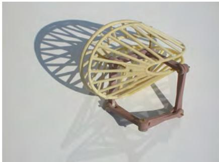
Abbildung 5: Würfel diagonale in sechsgliedriger Gelenk-Kette erzeugt in zeitlichem Verlauf die Oberfläche des Oloids. Modell: Werner Budde, Hochschule für Künste Bremen. Abbildung des Verfassers.
